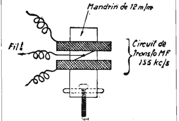
Fig. 2 - La bobina oscillatrice impiegata dall'Autore consiste in un vecchio trasformatore MF da 135 kHz.
