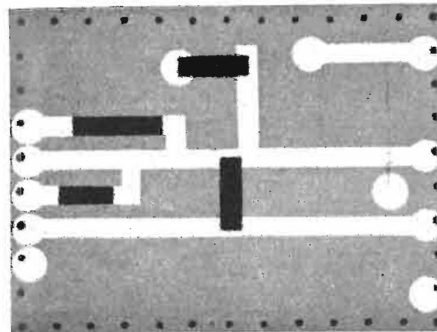
Il National Bureau of Standards ha realizzato delle resistenze sotto forma di nastro adesivo, che sono particolarmente utili per i circuiti stampati. La foto illustra appunto un circuito stampato dove vengono impiegati questi nuovi resistori.
