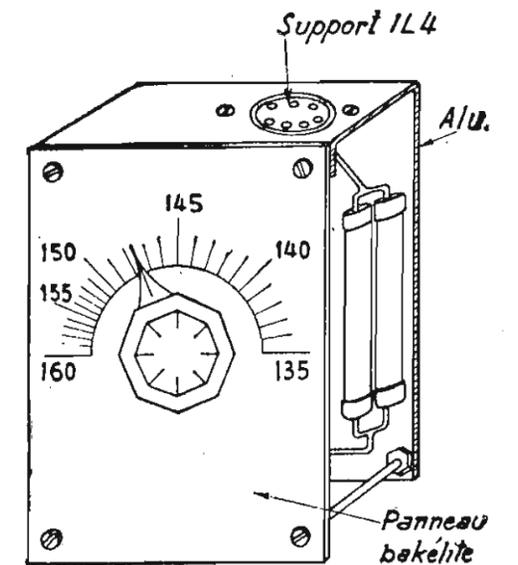
Fig. 3 - Disposizione consigliata per la realizzazione dell'oscillatore modulato miniatura descritto.
