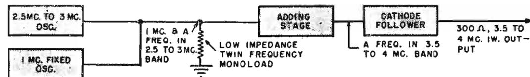
La figura illustra il circuito di principio del VFO descritto. Le frequenze generate dai due oscillatori non hanno nessuna armonica in corrispondenza delle bande dilettantistiche.
