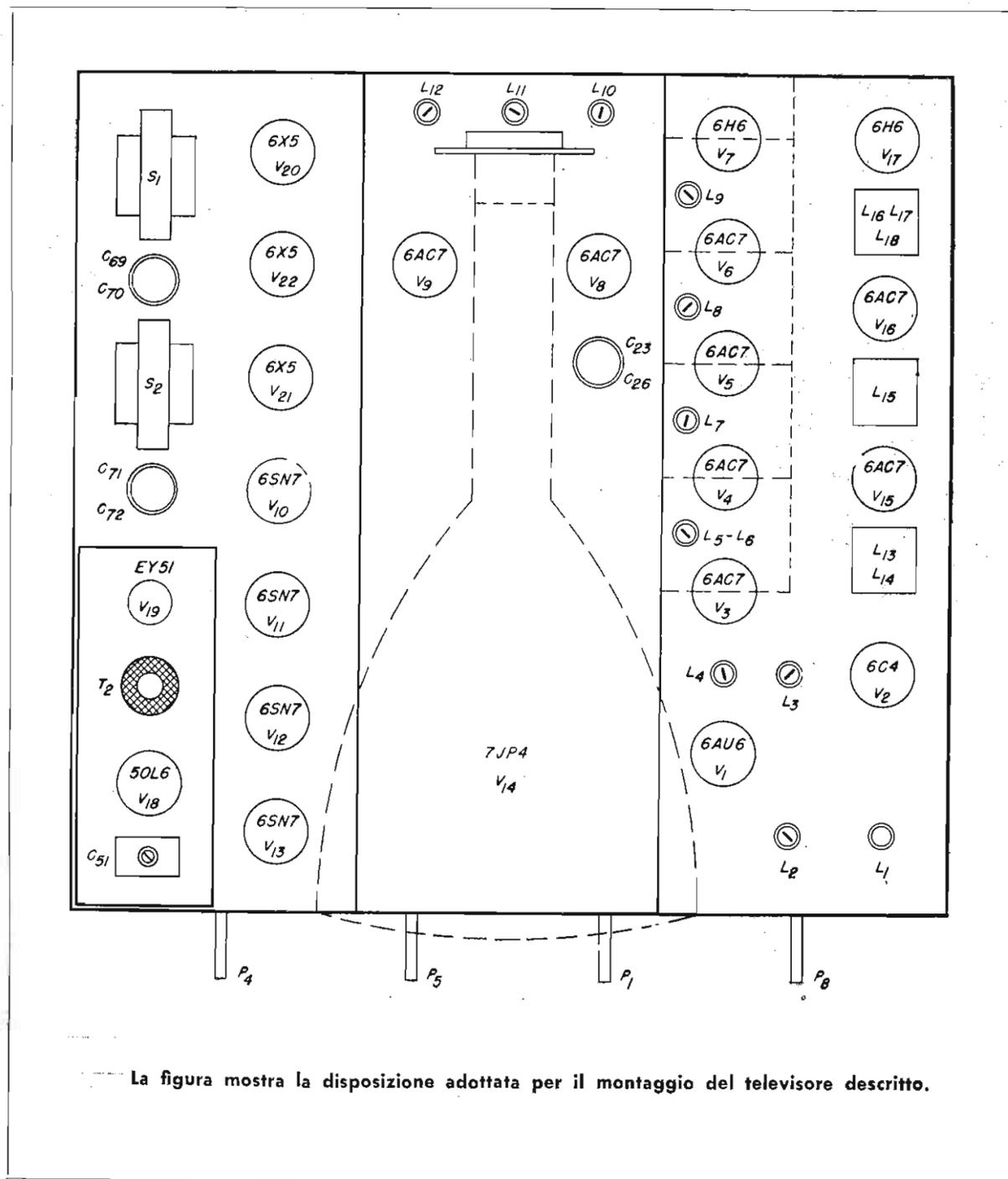
La figura mostra la disposizione adottata per il montaggio del televisore descritto.
