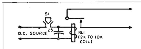
Per una costante di tempo di 5-6 secondi l'Autore ha impiegato un relè da 2.000 ohm, con circa 5.000 ohm in serie con l'avvolgimento, un raddrizzatore al selenio per 110 V ed un condensatore da 160 micro-F. Con un condensatore da 50 micro-F, un relè da 2.000 ohm ed una sorgente CC di 110 V la costante di tempo è di circa due secondi. Costanti di tempo superiori a dieci secondi si possono ottenere adoperando condensatori di capacità elevata e relè di elevata resistenza.
