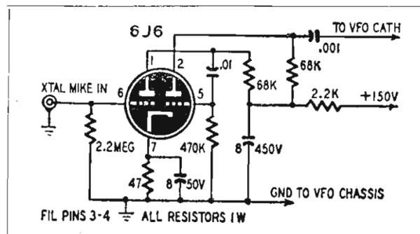
La placca della seconda sezione della 6J6 viene collegata al catodo dell'oscillatore esistente, quando esso costituisce un punto caldo per l'AF; se esso è invece collegato a massa, detto collegamento verrà eseguito alla griglia dell'oscillatore mediante un condensatore da 0.001 micro-F.
