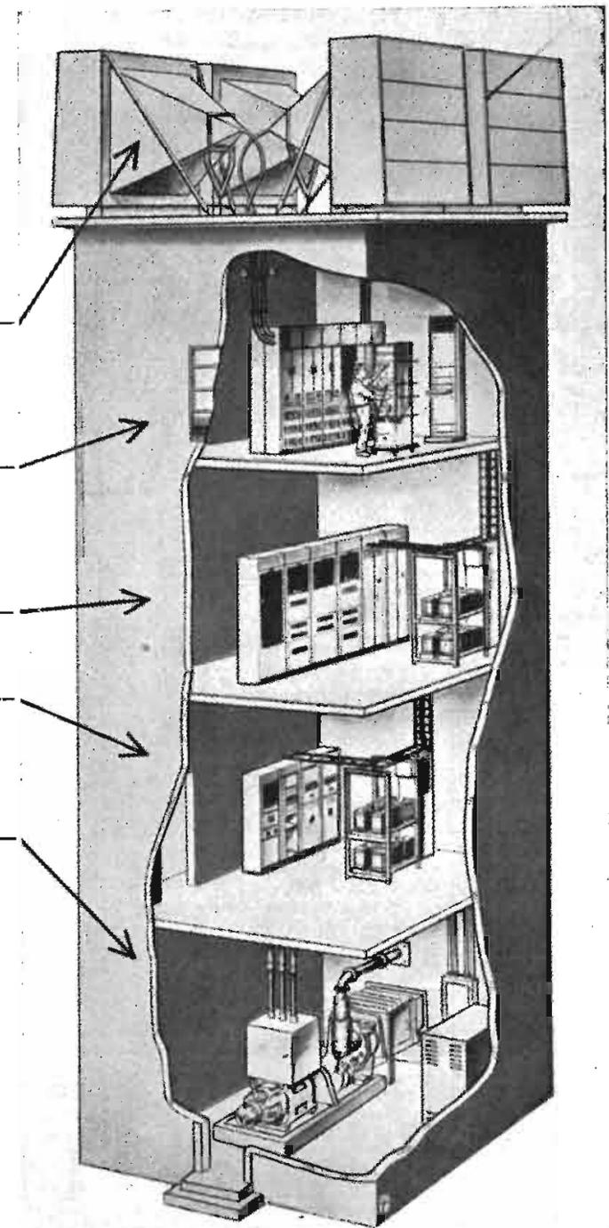
**Sul tetto** trovano posto le antenne che fanno capo ad una guida d'onda collegata all'apparecchiatura sottostante.
