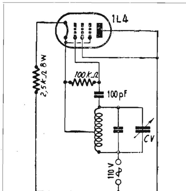
Fig. 1 - Circuito elettrico del semplice oscillatore modulato descritto. L'alimentazione anodica e quella di filamento sono ottenute direttamente dalla rete.
