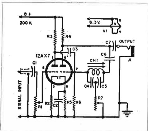
lo schema, impiega invece un circuito LC costituito dall'induttanza CH1, dei condensatori C4 e C5 e dalla resistenza R7. Vengono impiegati solo due stadi di amplificazione (un'unica valvola doppia) ed è ottenuta una discriminazione dell'ordine dei 50 db. I valori indicati per C4, C5 ed R7 sono per una frequenza di 1.000
