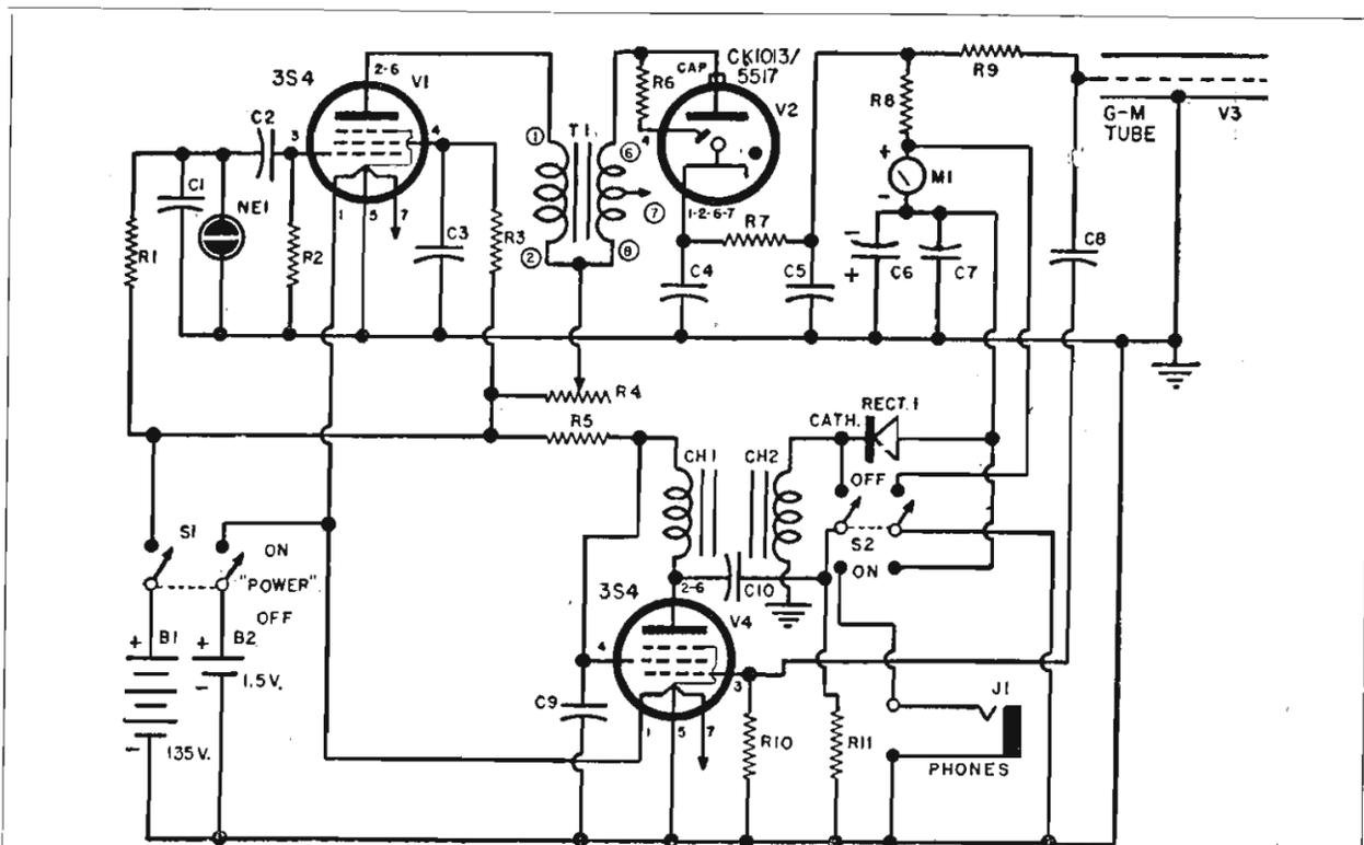
Circuito elettrico completo del contatore G-M descritto. L'alta tensione è fornita rettificando la tensione generata da un oscillatore con lampada al neon e può essere variata da 500 a 1250 V. Gli impulsi generati possono essere contati mediante una cuffia o uno strumento.
