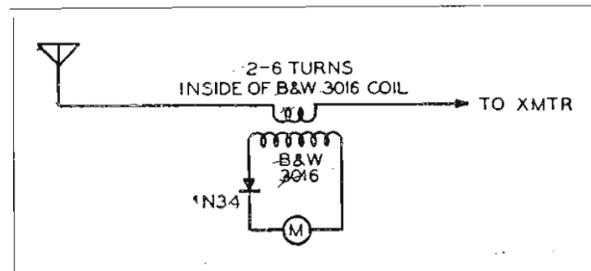
della bobina interna. Potrebbe essere necessario invertire la polarità del cristallo di germanio, allo scopo di ottenere il giusto senso di deflessione dell'indice dello strumento. Questo sistema non è consigliato per le frequenze più alte, in corrispondenza delle quali l'induttanza disposta in serie all'antenna può variare la sua impedenza.
