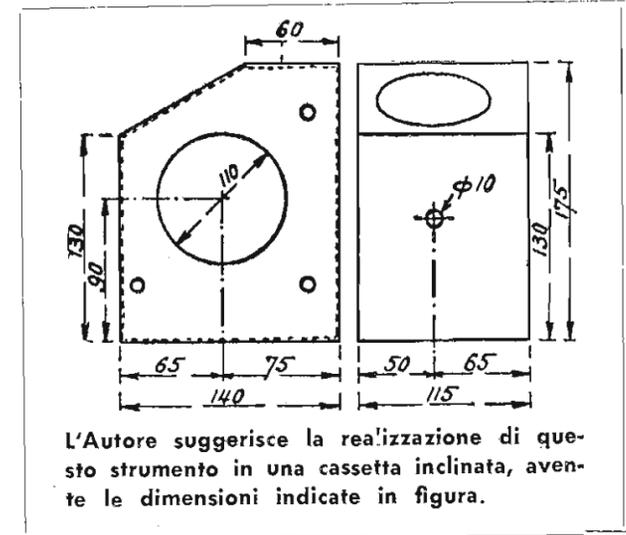
L'Autore suggerisce la realizzazione di questo strumento in una cassetta inclinata, avente le dimensioni indicate in figura.
